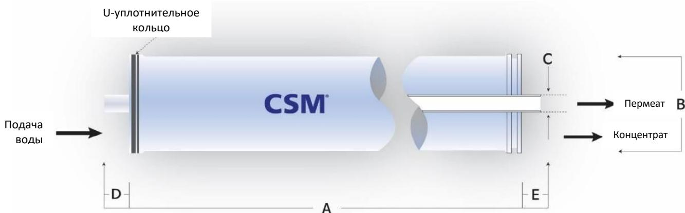
1. Каждый мембранный элемент поставляется в комплекте с одним соединителем(муфтой) и четырьмя уплотнительными кольцами.
